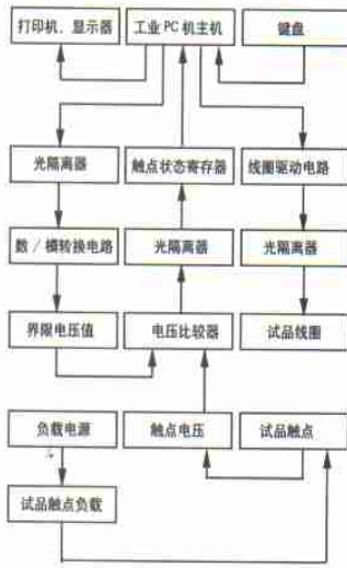
图 2 试验装置结构框图
