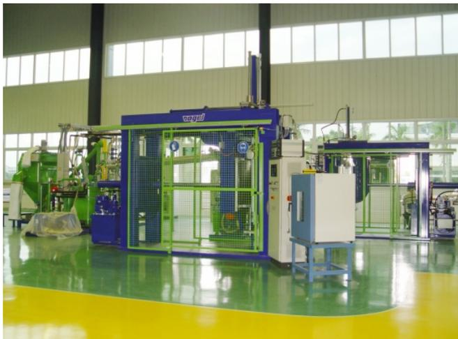
德国HEDRICH公司的全自动数控环氧树脂真空混料/压力成型系统生产
