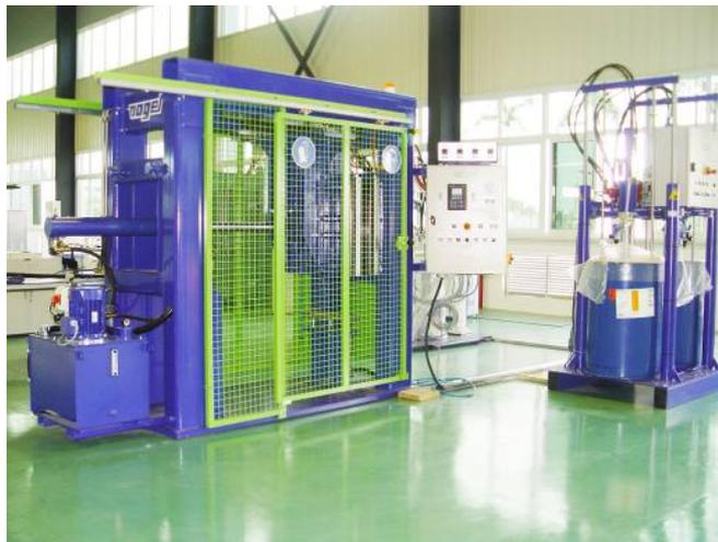
瑞士VOGEL公司的全自动数控硅橡胶混料/压力成型系统生产。
